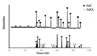
Gambar 5. Hasil XRD SiC tanpa spinel (MgAl $_2$ O $_4$ ) dan SiC dengan spinel (MgAl $_2$ O $_4$ ) (Ayu, 2010).
