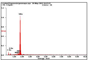
Gambar 9. Grafik EDAX SiC terlapisi spinel dengan Mg 3 gram.
