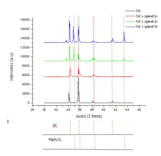
Gambar 4. Hasil XRD SiC tanpa spinel (MgAl $_2$ O $_4$ ) dan SiC dengan spinel (MgAl $_2$ O $_4$ ).
