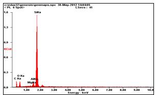
Gambar 7. Grafik EDAX SiC terlapisi spinel dengan Mg 0.6 gram.
