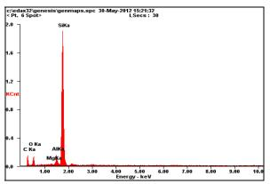
Gambar 8. Grafik EDAX SiC terlapisi spinel dengan Mg 1.2 gram.
